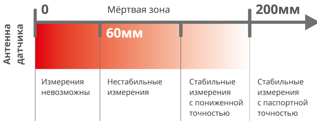
Рис. 5. Структура «мертвой зоны» датчика eurosens MWS
